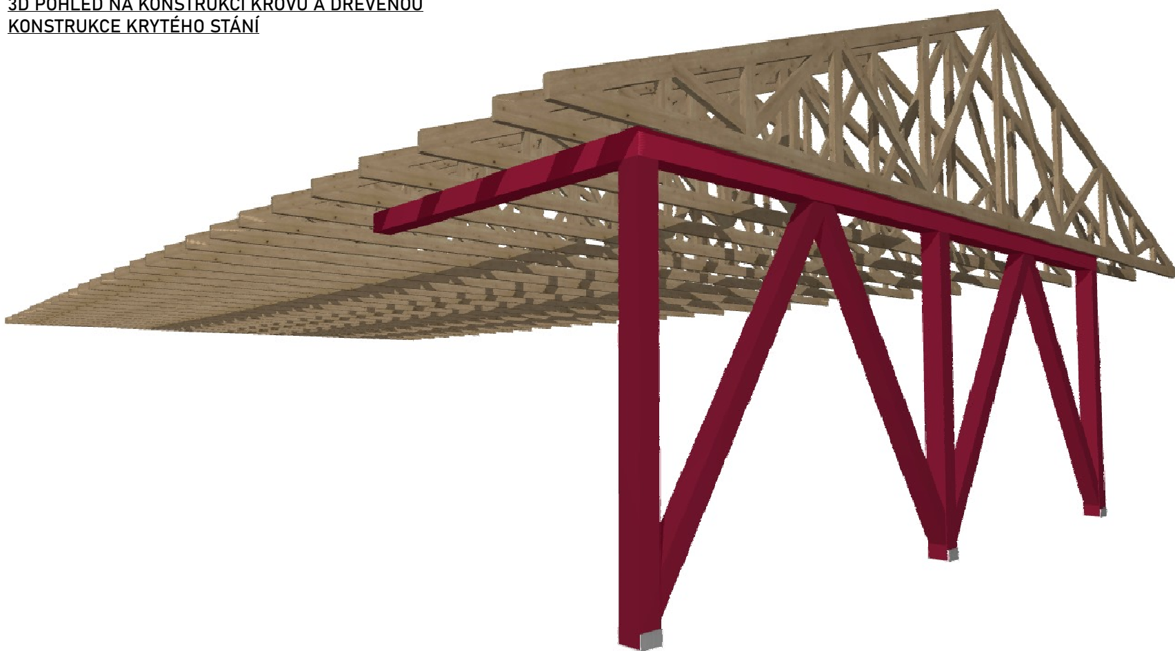
3D POHLED NA KONSTRUKCI KROVU A DŘEVĚNOU KONSTRUKCE KRYTÉHO STÁNÍ
